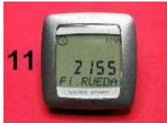
Función 11: Diámetro de rueda del vehículo para el ajuste del odómetro (pulsar el botón SET )
