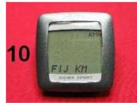
Función 10: Tipo de medición (Km/h ó Mph) y tipo horario (12 h / 24 h) (pulsar el botón posterior SET )
